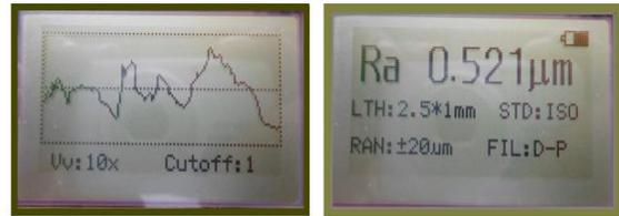
**Fig.5** Graphe et la valeur de rugosité obtenu par le rugosimètre d'une pièce rectifiée.
