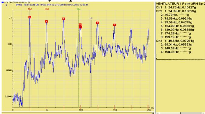
**Fig. 1. Spectre du palier moteur**
