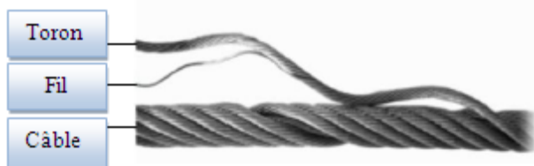
Figure 1 : Eléments constitutifs d'un câble métallique.
