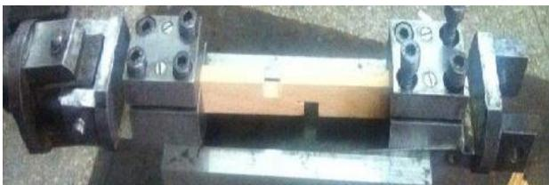
Figure 2 : l'éprouvette placée dans le dispositif d'amarrage
