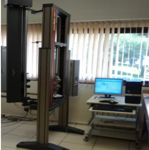
Figure 2 : la machine de traction «Zwick Roell»
