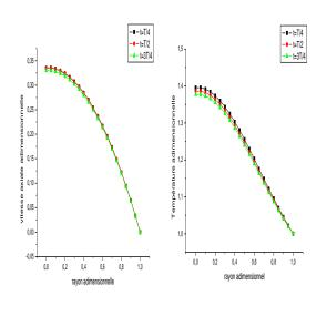
Figure 3 : Profil de la vitesse axiale et de la température adimensionnelle en fonction du rayon adimensionnel.
