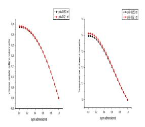
Figure 1 : profil de la vitesse axiale et de la température adimensionnelle en fonction de rayon en z=L/4 pour deux valeurs de l'angle au sommet du cône  $\Psi$
