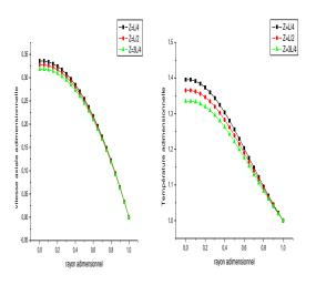
Figure 2 : Profil de la vitesse axiale et de la température adimensionnelle en fonction du rayon adimensionnel.
