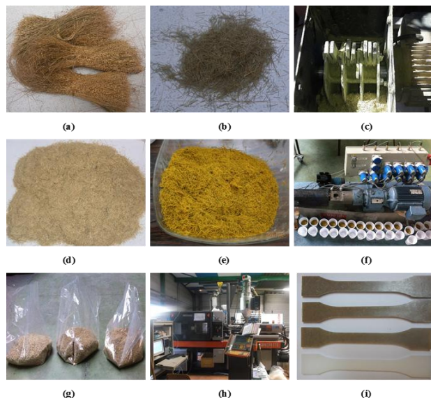
Figure 1. Le processus d'Elaboration des composites renforcés par la fibre d'alfa : a) les tiges séchées, b) Les morceaux de tiges coupés, c) le broyeur, d) fibres non traitées, e) fibres traitées, f) extrusion ; g) compounds ; h) injection, i) éprouvettes.
