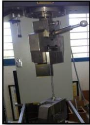
Figure 2. Montage expérimental et éprouvette toron extraite d'un câble
