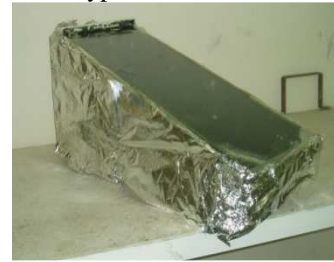
Figure 2 : distillateur solaire avec une isolation en bois bien sec peint en blanc avec film d'aluminium.
