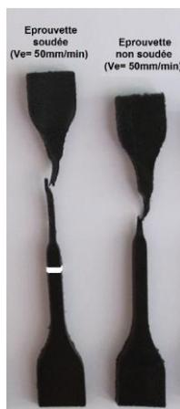
Fig.6. Aspect de l'éprouvette non soudée et soudée par bout à bout après l'essai de traction.
