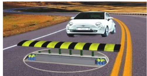
Figure 1: schéma descriptif du ralentisseur intelligent
