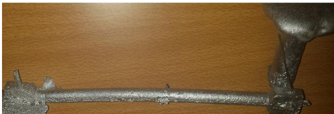
Figure 4 : Éprouvette sans crique fabriquée en moule sable
