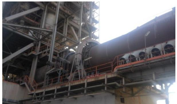
Figure 1. Four rotatif dans une cimenterie de la région de Settat au Maroc.
