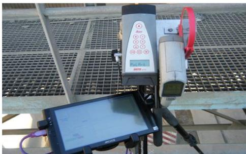
Figure 2. Instruments de mesure de l'ovalité
