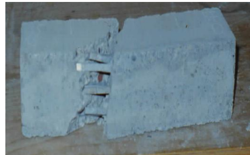
Figure 3 : Mode de rupture d'une éprouvette armée de fibres droites.
