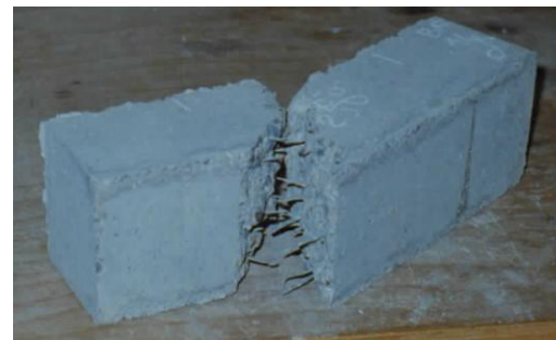
Figure 2 : Mode de rupture d'une éprouvette armée de fibres ondulées droites.
